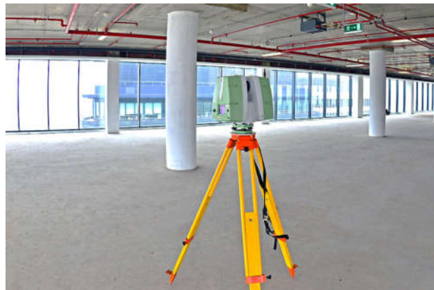
Рис. 8. Лазерный сканер Leica.
